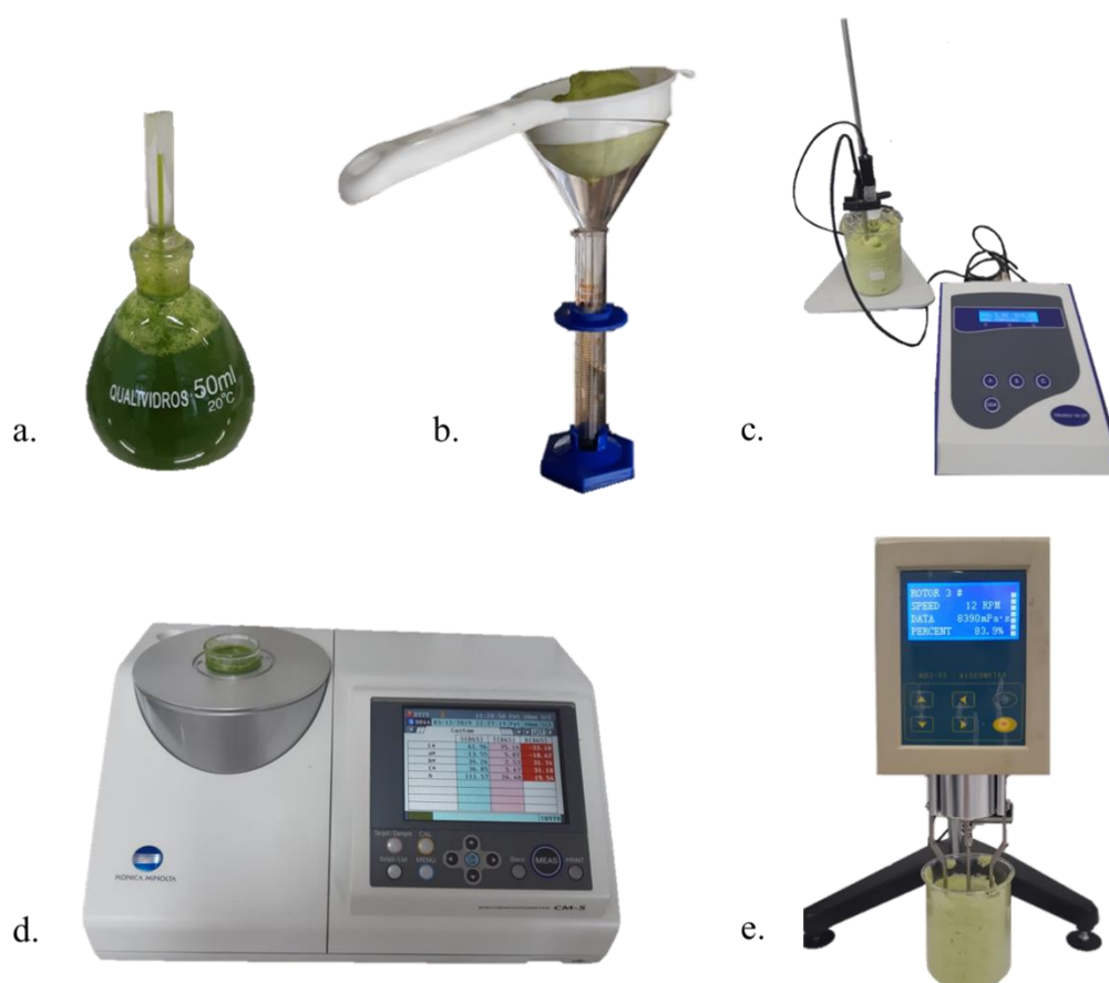
Figura 5 – Experimento para determinação da densidade (a), estabilidade (b), pH (c), cor (d) e viscosidade (e).
