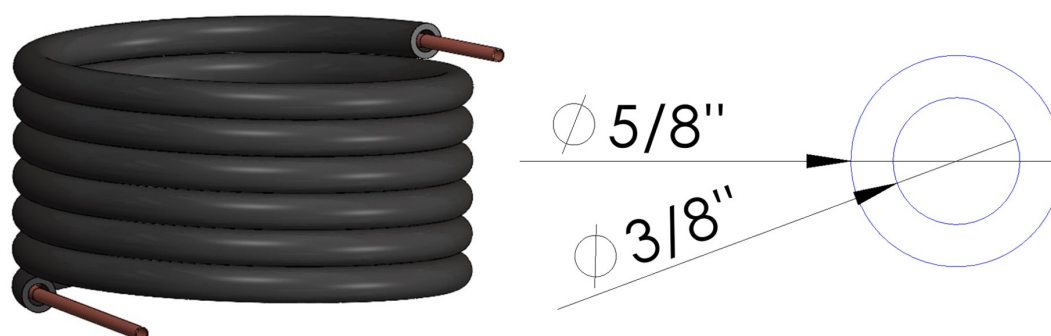
Figura 6.23: Montagem entre serpentina e mangueira de água. Fonte: Arquivo Pessoal.
