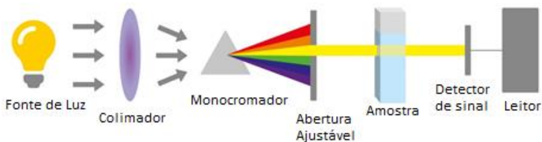
Figura 4 — Esquema de funcionamento de um espectrofotômetro
