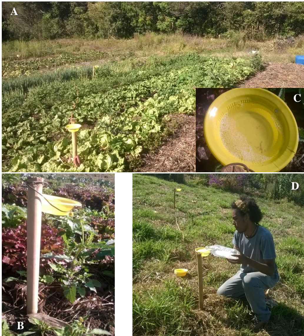
Figura 3 - Instalação das armadilhas na Horta: (A) visão geral da horta; (B) armadilha montada na haste de bambu; (C) prato com solução salina (D) Adição da solução salina nos pratos. Lavras, Bairro Fonseca, setembro de 2019.
