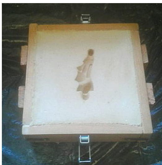
Figura 5.7 – Experimento de confecção do molde com areia verde própria para fundição.
