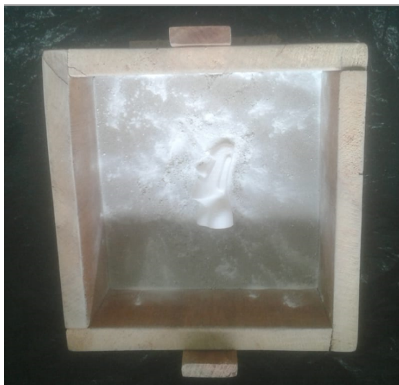
Figura 4.4 – Caixa inferior de moldagem com desmoldante sobre parte do modelo bipartido.
