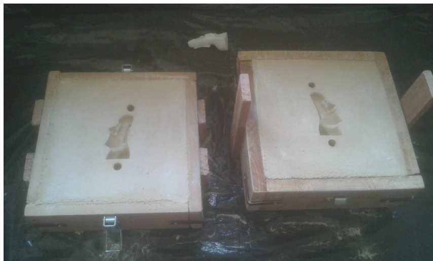
Figura 4.9 – Partes do molde com o negativo do modelo.
