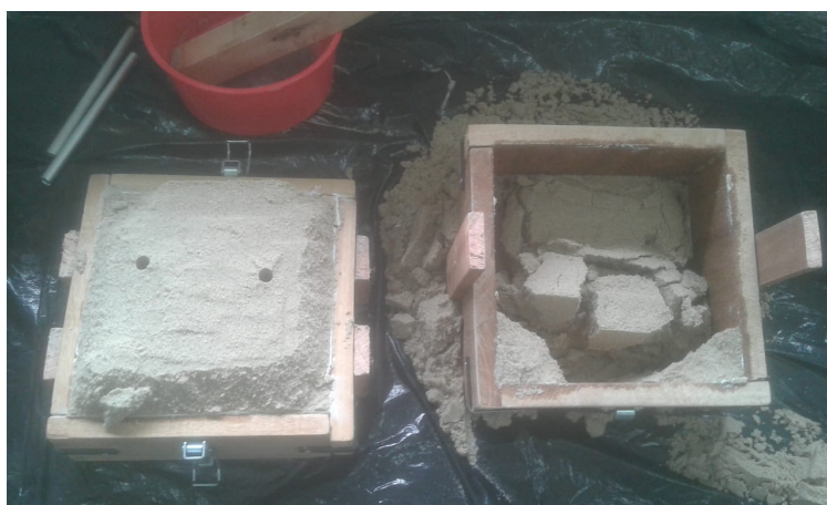
Figura 5.6 – Experimento de confecção do molde com areia de praia.
