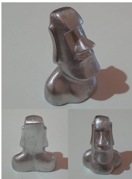
Figura 5.4 – Produto final após realizada a limpeza e polimento.
