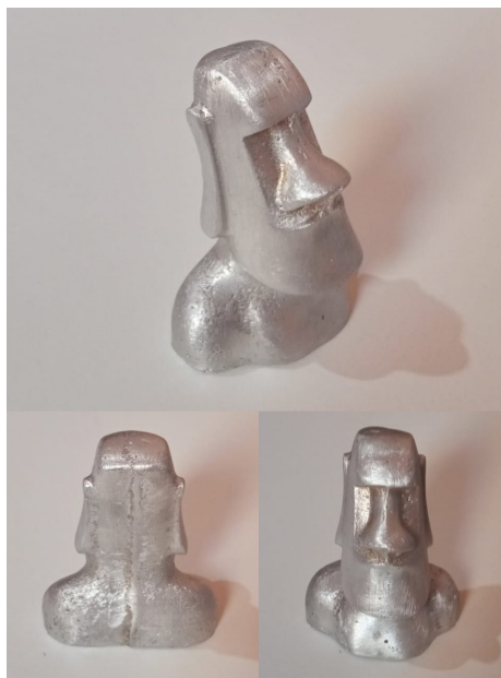
Figura 5.3 – Produto após a rebarbação.
