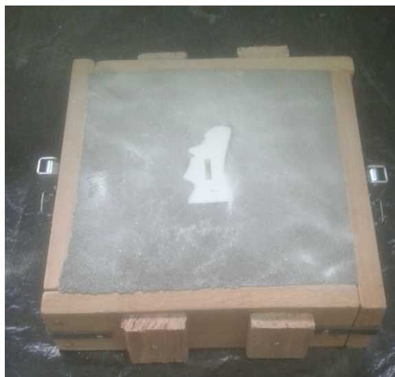
Figura 4.6 – Caixa inferior de moldagem com desmoldante sobre parte do modelo bipartido.
