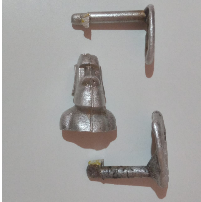
Figura 5.2 – Produto com os canais de alimentação e respiro cortados.
