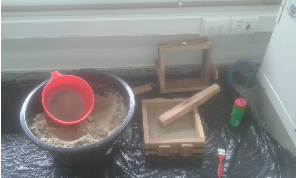
Figura 4.5 – Caixa inferior de moldagem após ser coberta e compactada pela areia de faceamento.
