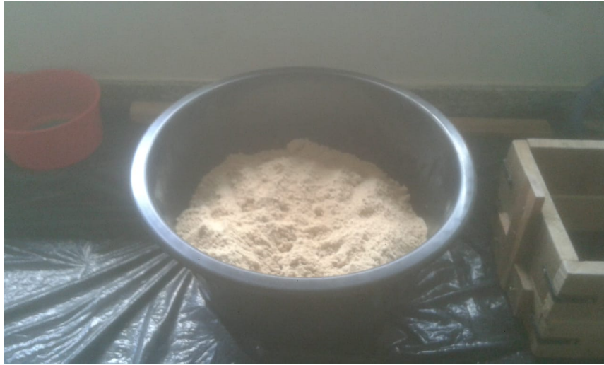
Figura 4.3 – Areia verde utilizada na fundição.
