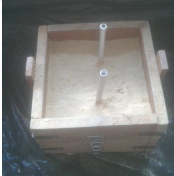
Figura 4.8 – Partes do molde com o negativo do modelo.
