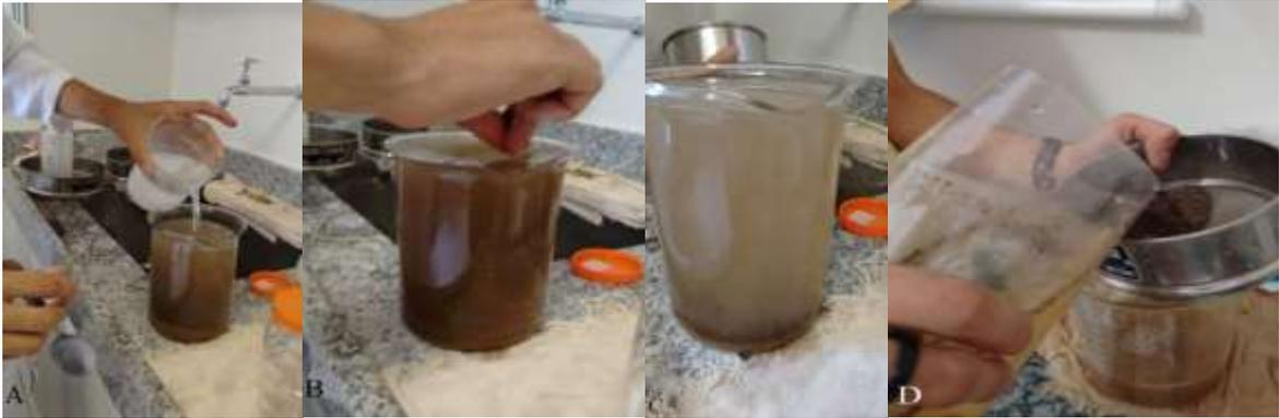
**Figura 3.** Flotagem do sedimento de fundo, da última peneira (0,2 mm). A e B –Mistura de solução salina com sedimento de fundo e água. C–Flutuação da matéria orgânica e D– Filtração. Fonte:Albertino Fonseca, G.
