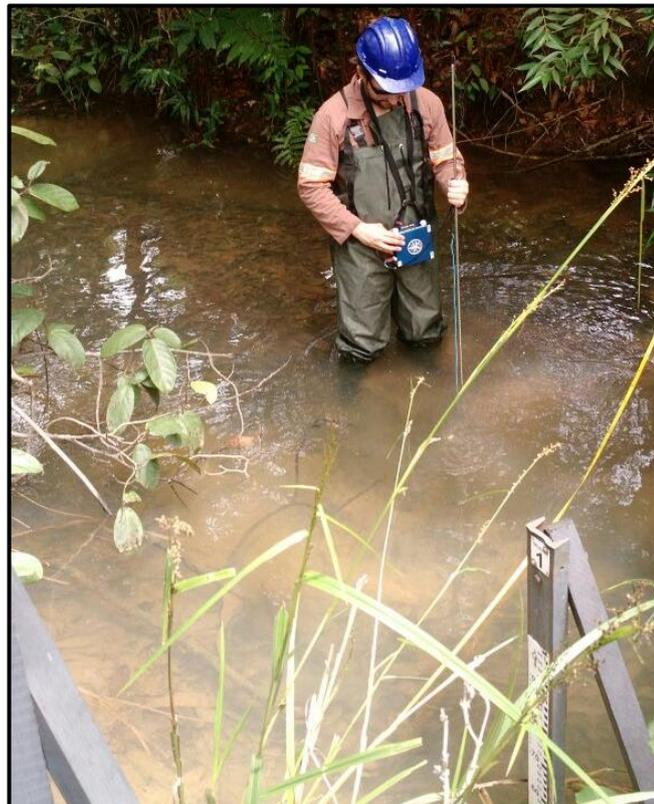
**Figura 3.** Medição de vazão com uso do micromolinete modelo MCN-1C. **Fonte:** ASP Engenharia, 2018.
