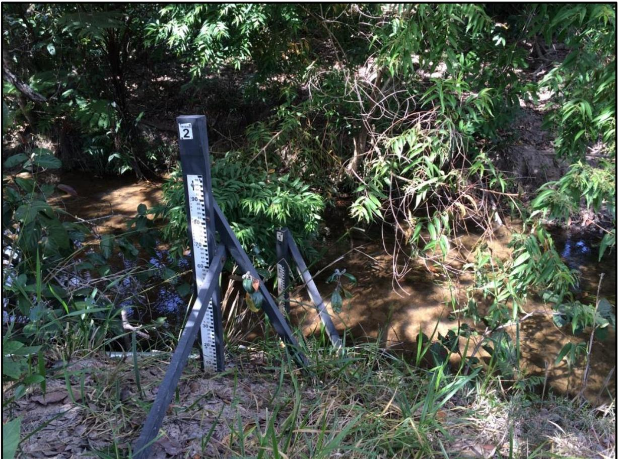
**Figura 6.** Régua Linimétrica instalada no Ribeirão do Gama.
