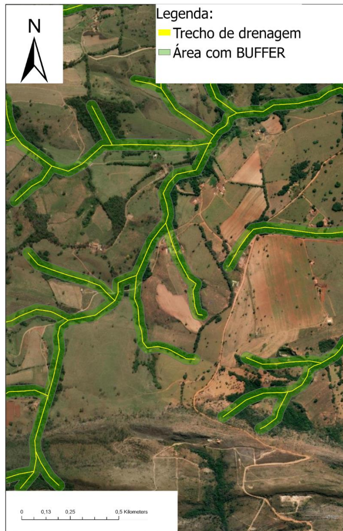
Figura 2: Exemplo de área criada com a ferramenta “Buffer” delimitando a APP de 30 metros no entorno de rios de largura inferior a 10 metros.
