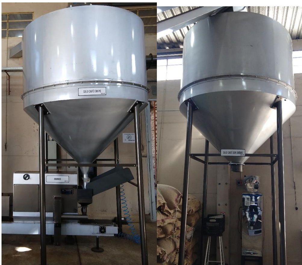
Figura 6 – Silos de armazenamento dos cafés em grão
