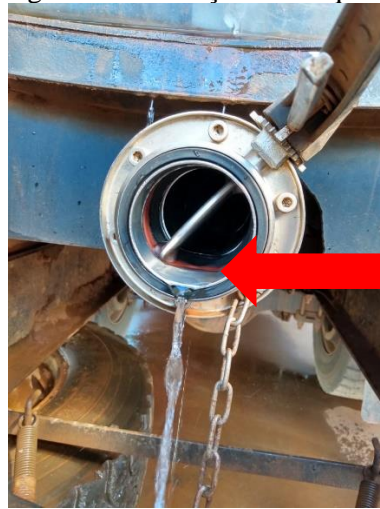
Figura 12 - Higiene da tubulação do tanque do caminhão.
