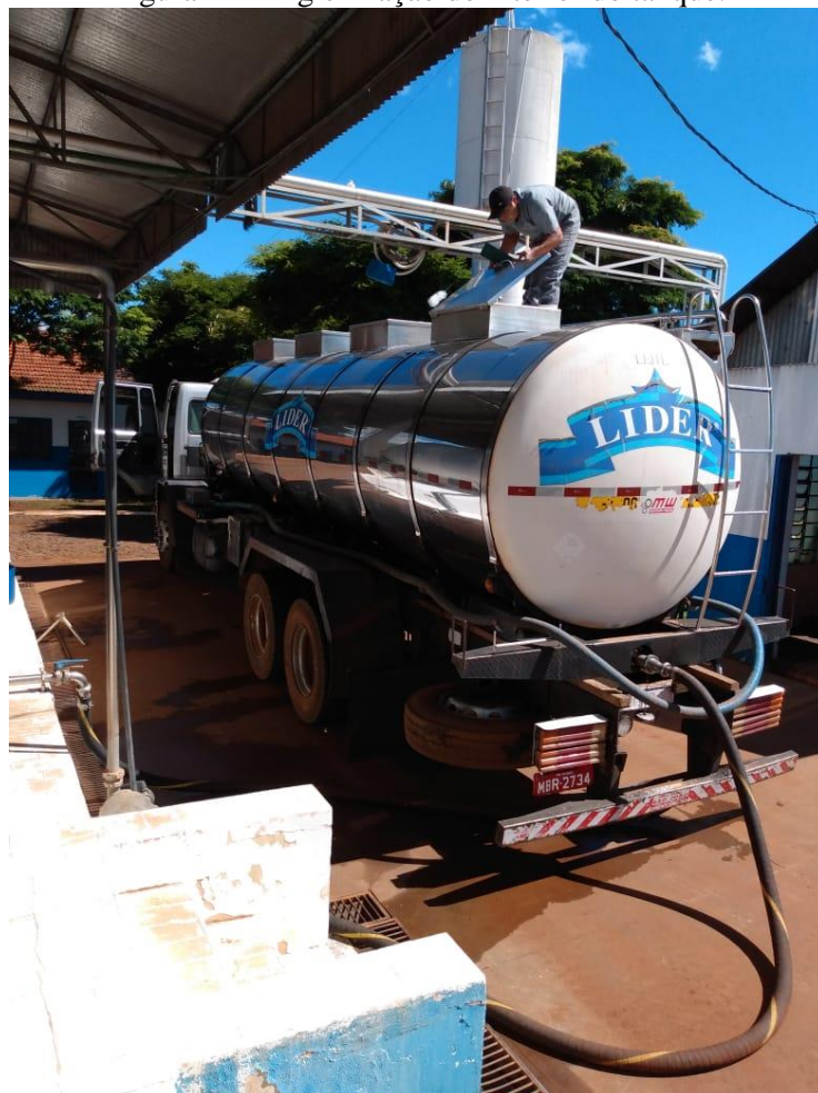
Figura 11 - Higienização do interior do tanque.
