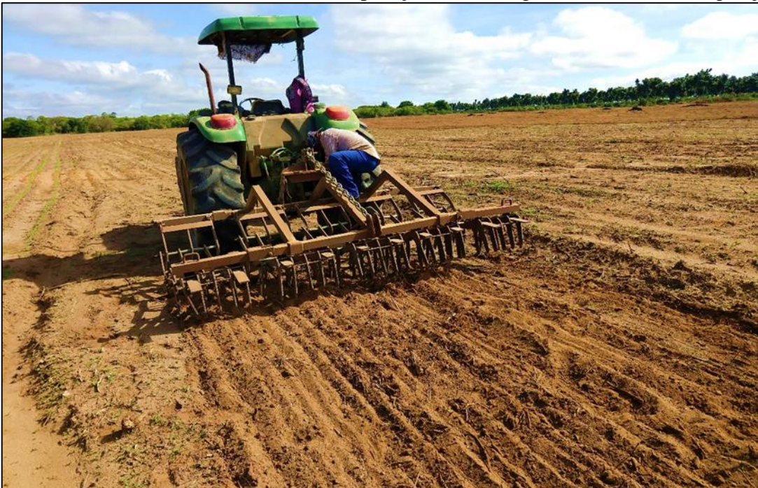
Figura 5 - Trator John Deere realizando a operação de rastelagem em área total do gotejo 4
