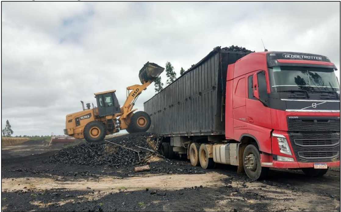
Figura 25 - Pá carregadeira realizando o carregamento do biorredutor no caminhão apropriado para o transporte
