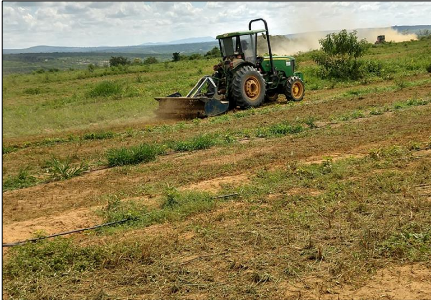
Figura 18 - Operação de trituração da mato-competição nas entre linhas do café. O implemento (trinchador) reduz o tamanho das plantas daninhas
