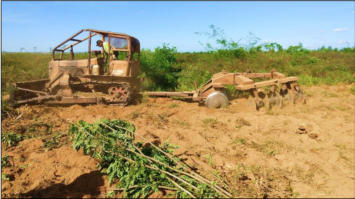
Figura 3 - Trator D7- FIATALLIS com grade aradora no preparo da nova área do gotejo 4
