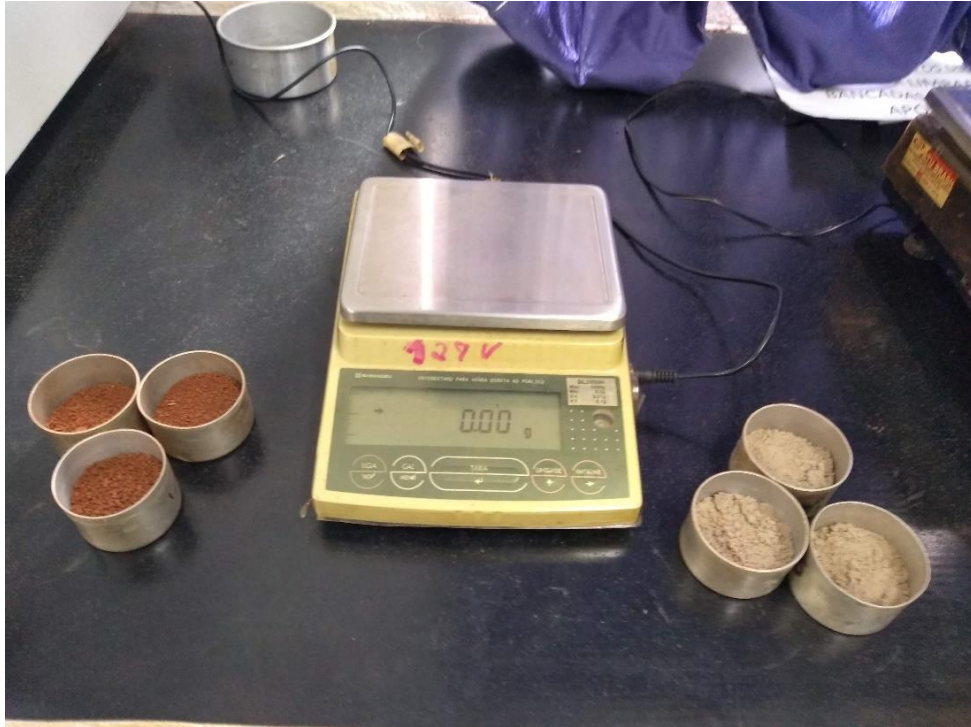
Figura 8: Balança para aferição da massa das amostras de solo argiloso (à esquerda) e arenoso (à direita)
