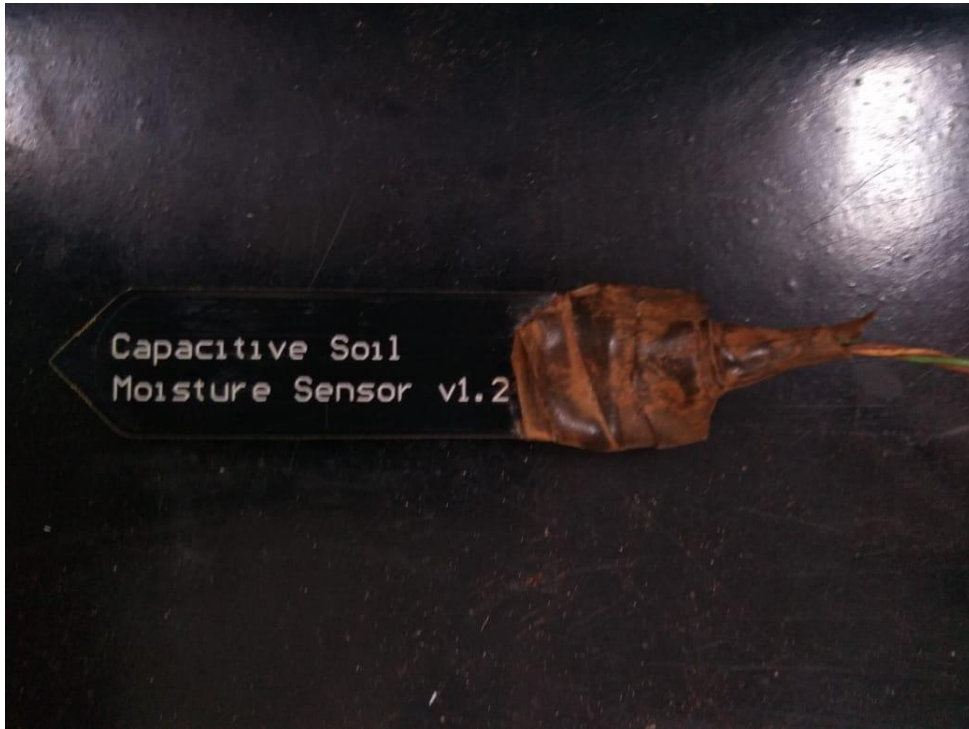
Figura 7: Sensor capacitivo alternativo de baixo custo
