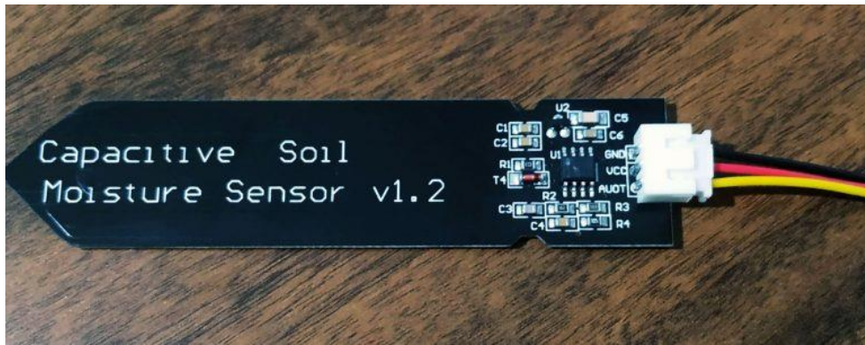
Figura 3: Sensor de umidade do tipo capacitivo
