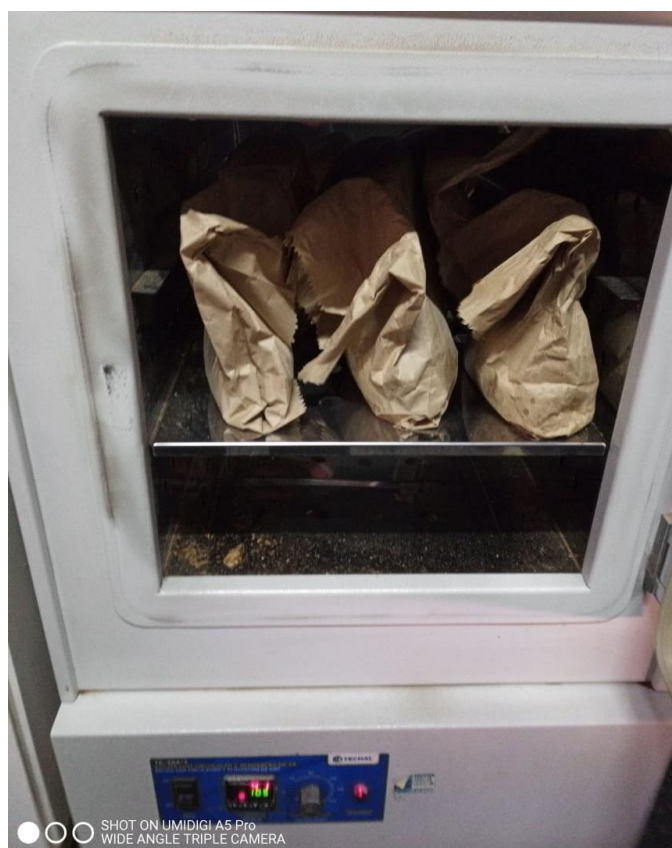
Figura 28 - Estufa de ventilação forçada
