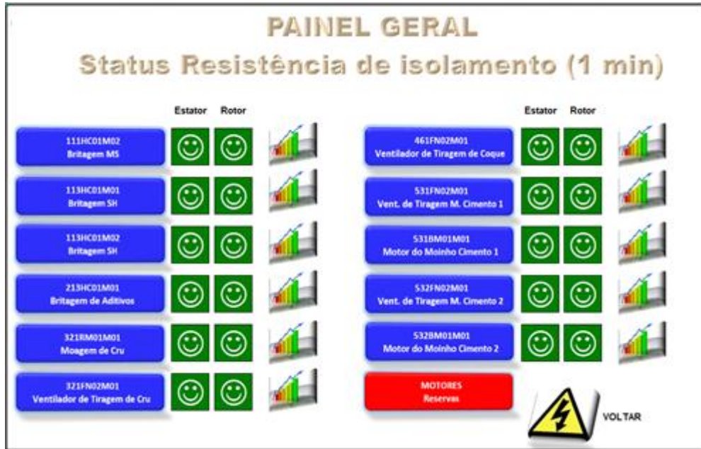
Figura 12 - Arquivo de registro de ensaios estáticos em motores de média tensão
