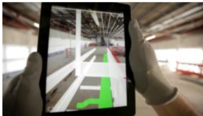
Figura 2.12 – Esquemas virtuais de sistemas sobrepostos à construção.
