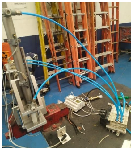
Figura 28 - Teste de bancada, fazendo a comunicação entre CLP e robô manipulador.
