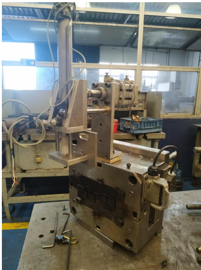
Figura 29 - Robô manipulador fixado na parte móvel do molde.
