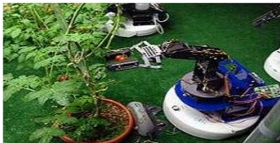
Figura 4 – Robô móvel para colheita de tomates
