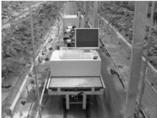
Figura 3 – Robô móvel para colheita de morangos
