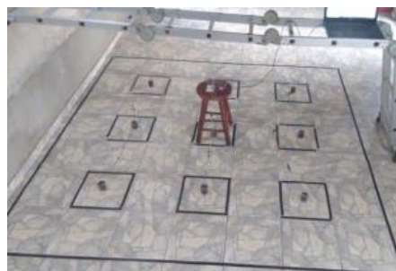
Figura 18. Ambiente de simulação com os sensores de umidade devidamente montados.
