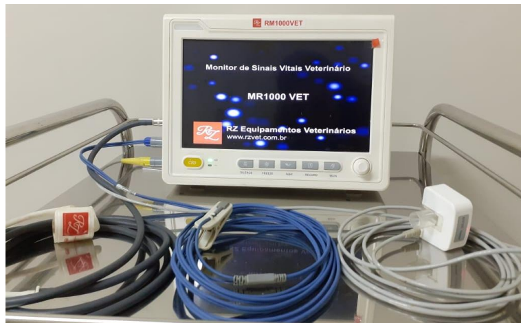
Figura 6 - Monitor de sinais vitais RZ multiparamétrico, com cabos de aferição de pressão arterial não invasiva, oximetria e capnometria, pertencentes a Dra. Manuela.
