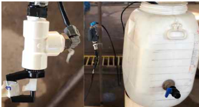
Figura 3 - Sistema montado para medição da vazão e da pressão do microaspersor Implebrás.
