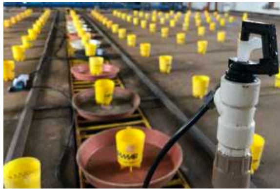
Figura 4 - Malha de coletores e microaspersor instalados.
