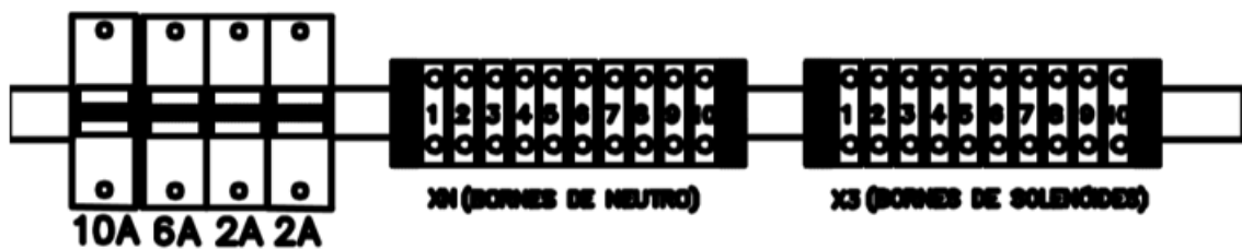
Figura 2.21 – Ampliação nos desenhos do painel: disjuntores e bornes
