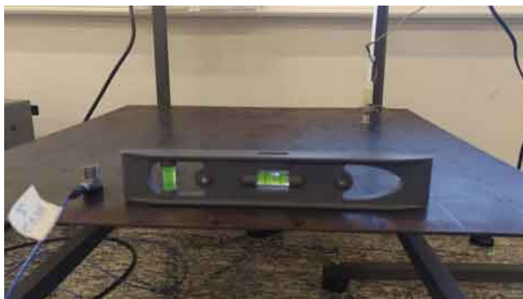
Figura 4.4 – Aferição do nivelamento e acoplamento do stinger à estrutura.
