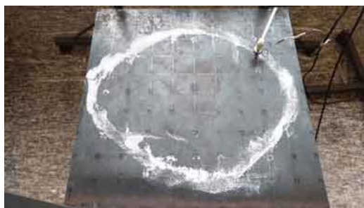
Figura 35 – Visualização experimental do modo de vibrar da placa em 71.5 Hz.
