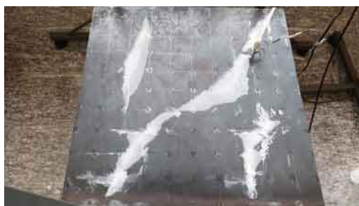
Figura 36 – Visualização experimental do modo de vibrar da placa em 95 Hz.
