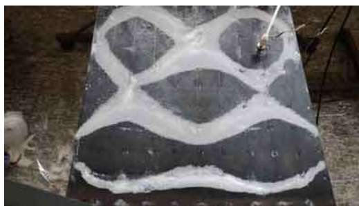
Figura 44 – Visualização experimental do modo de vibrar da placa em 349.5 Hz.
