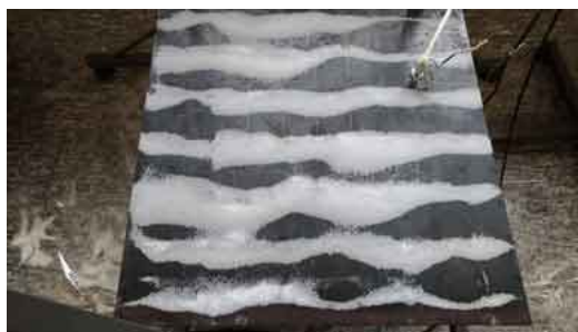
Figura 53 – Visualização experimental do modo de vibrar da placa em 1.18 KHz.
