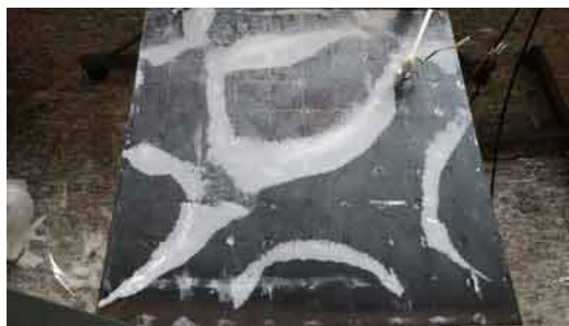
Figura 41 – Visualização experimental do modo de vibrar da placa em 289.5 Hz.
