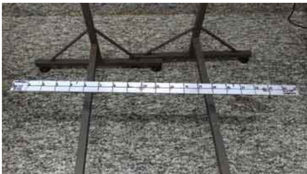
Figura 5.41 – Suspensão da viga por fios de nylon pelos nós 5 e 17.
