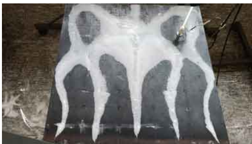
Figura 49 – Visualização experimental do modo de vibrar da placa em 548.5 Hz.
