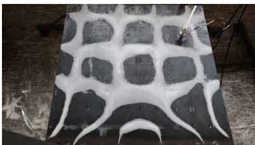
Figura 50 – Visualização experimental do modo de vibrar da placa em 786.5 Hz.
