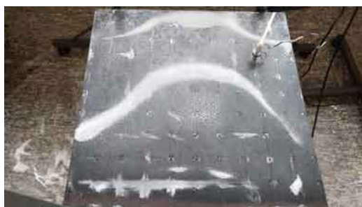
Figura 39 – Visualização experimental do modo de vibrar da placa em 180 Hz.
