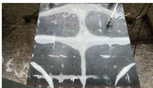
Figura 40 – Visualização experimental do modo de vibrar da placa em 220.5 Hz.
