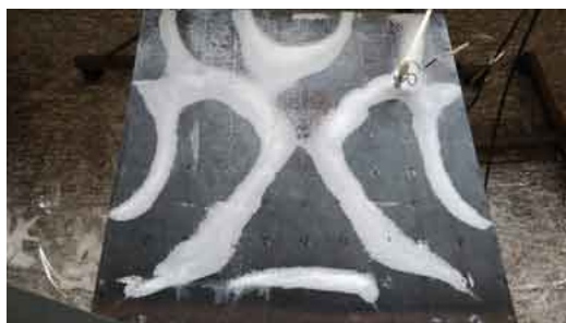
Figura 48 – Visualização experimental do modo de vibrar da placa em 453.5 Hz.
