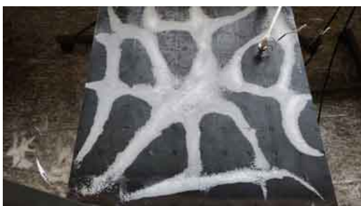
Figura 51 – Visualização experimental do modo de vibrar da placa em 824 Hz.
