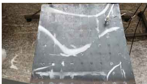
Figura 38 – Visualização experimental do modo de vibrar da placa em 171.5 Hz.
