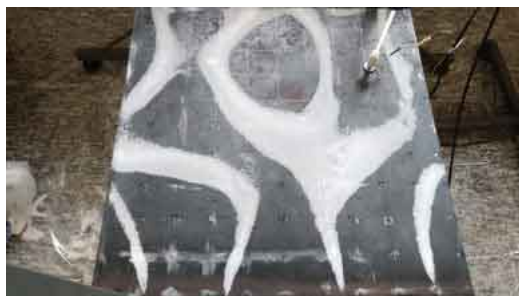
Figura 45 – Visualização experimental do modo de vibrar da placa em 365 Hz.
