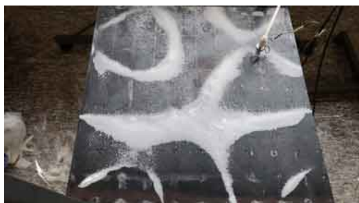
Figura 46 – Visualização experimental do modo de vibrar da placa em 372.5 Hz.
