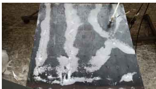
Figura 43 – Visualização experimental do modo de vibrar da placa em 328.5 Hz.
