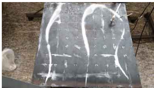
Figura 37 – Visualização experimental do modo de vibrar da placa em 163 Hz.
