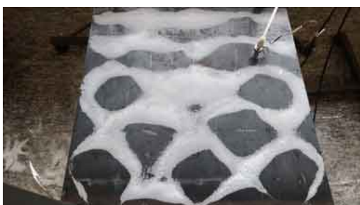
Figura 52 – Visualização experimental do modo de vibrar da placa em 853 Hz.
