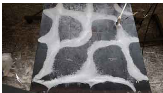
Figura 47 – Visualização experimental do modo de vibrar da placa em 426 Hz.
