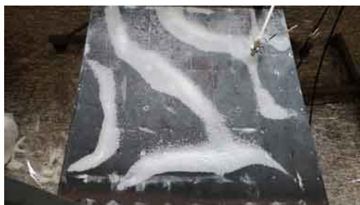
Figura 42 – Visualização experimental do modo de vibrar da placa em 291.5 Hz.
