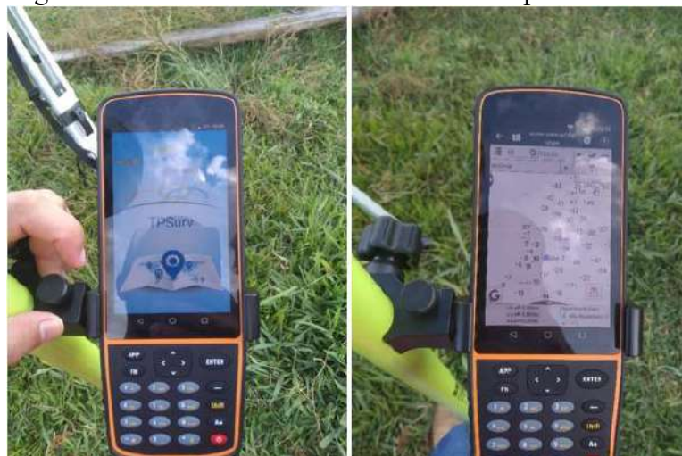
Figura 10 – Coletora usada no levantamento planialtimétrico.
