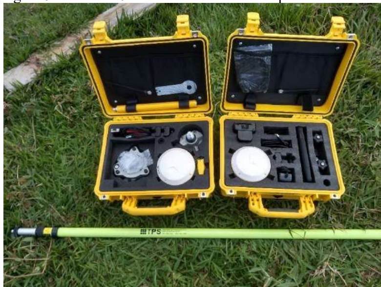
Figura 9 – GPS T10 usado no levantamento planialtimétrico.
