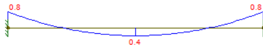
Figura A.4 – Diagrama de Momento Fletor para a viga biengastada com carregamento uniformemente distribuído obtido no software Ftool
