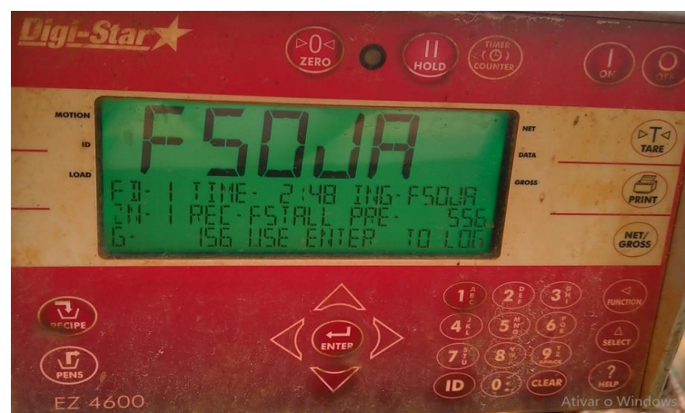
Figura 38- Balança de precisão do vagão misturador funcionando no abastecimento de farelo de soja.
