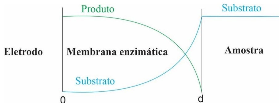
Figura 8 – Representação gráfica operacional do biossensor potenciométrico.
