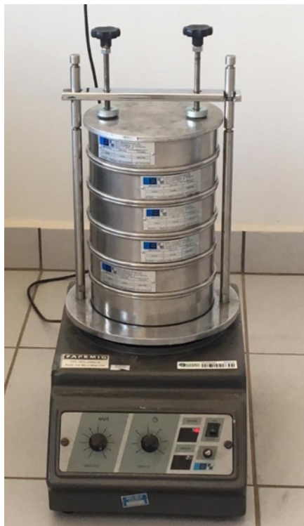
Figura 3.1 – Agitador de peneiras eletromagnético
