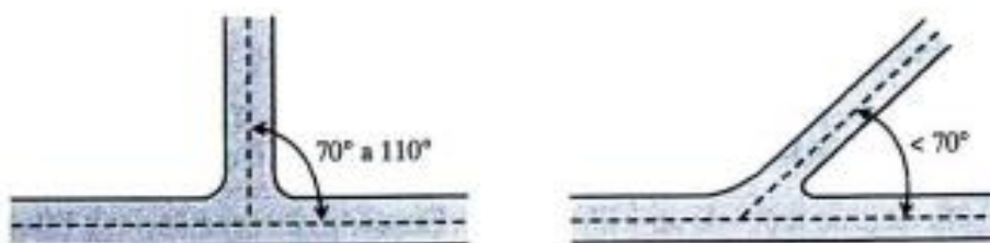
Figura 8: Representação da interseção com três ramos.
