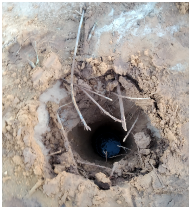
Figura 4.1 – Furo com qualidade afetada pela presença de raízes
