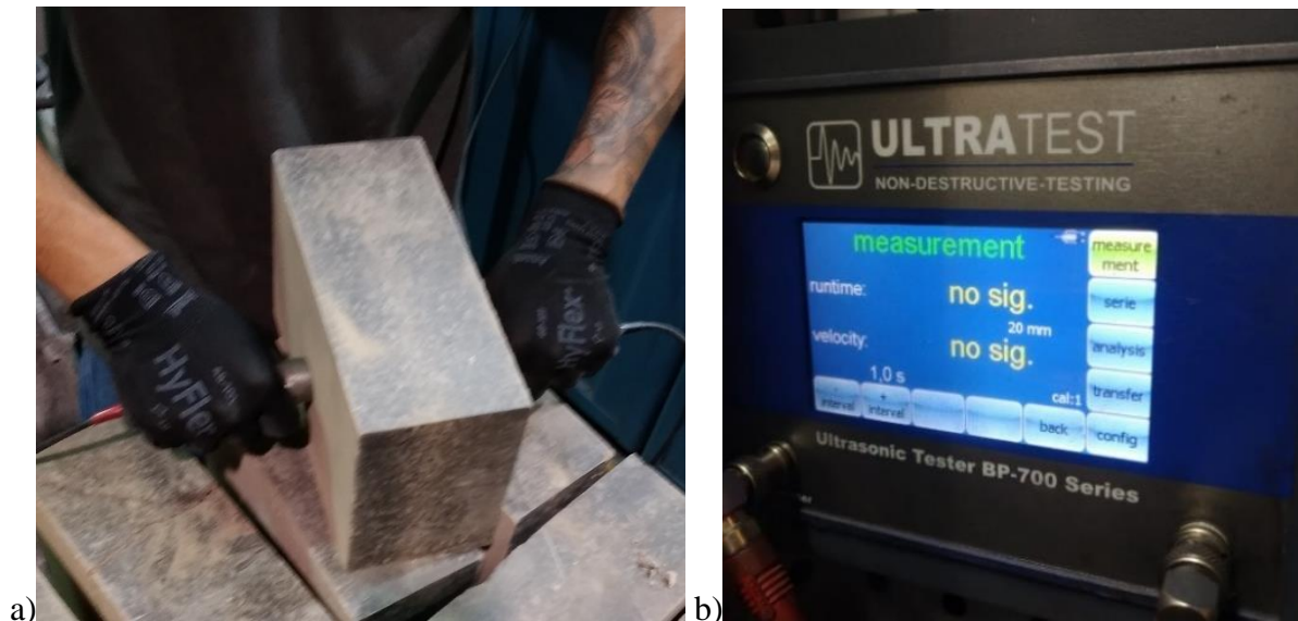
Figura 3.3 – a) Representação da medição de ultrassom usando dois transdutores e b) aparelho de ultrassom da marca Ultratest utilizado para inspeção dos tijolos.
