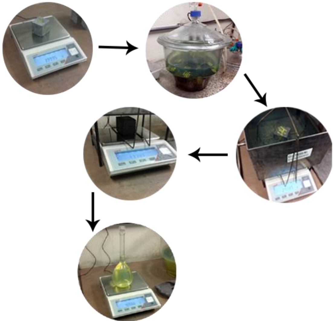
Figura 3.5 – Esquema do método de medida da porosidade aparente e densidade aparente dos corpos de prova.
