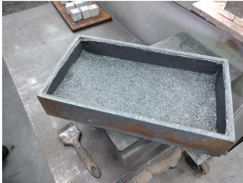
Figura 3.6 – Caixa refratária preenchida com grafite para imersão dos corpos de prova.
