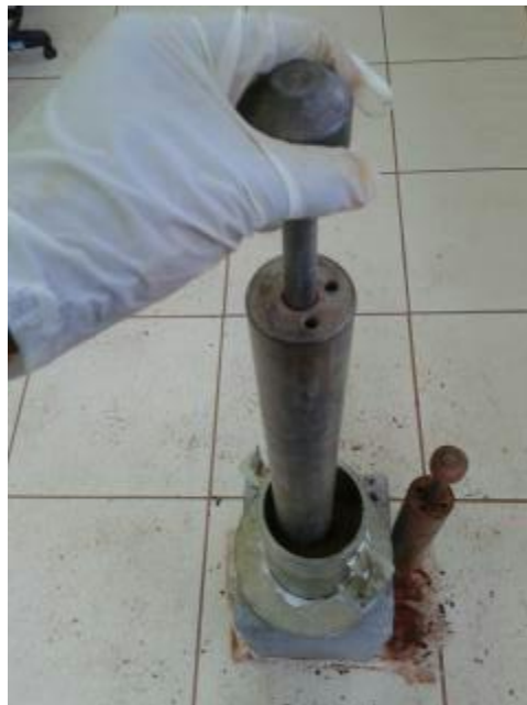
Figura 1 - Instrumentos relativos ao ensaio Proctor Normal
