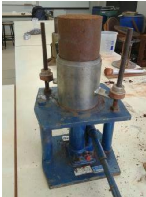
Figura 2 - Extração do material compactado
