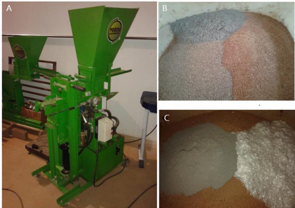
Figura 5 – Maquinário e materiais utilizados na produção dos tijolos solo cimento
