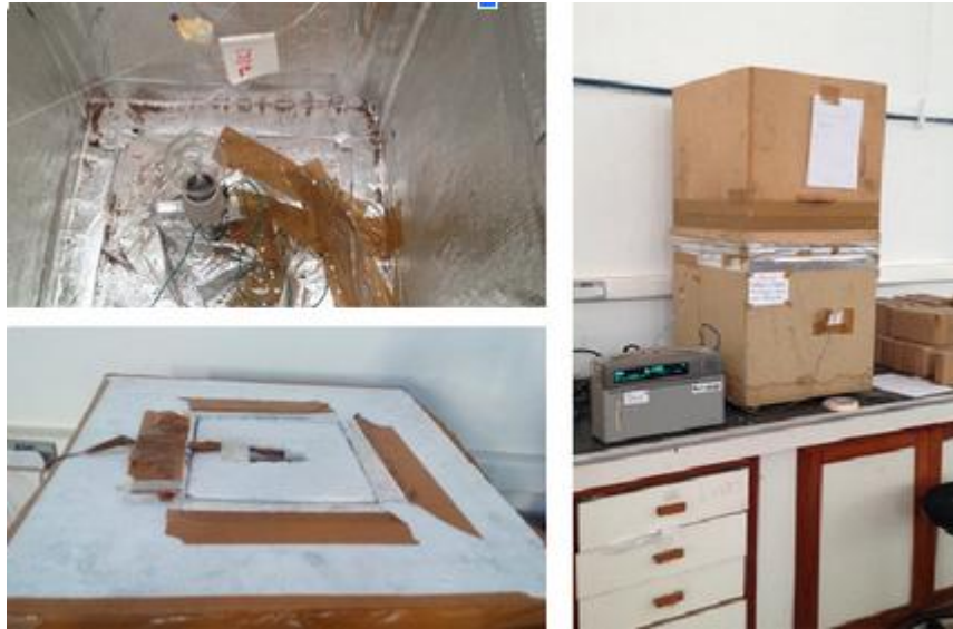
Figura 7 - Dispositivo utilizado para determinação da condutividade térmica nos tijolos solo cimento
