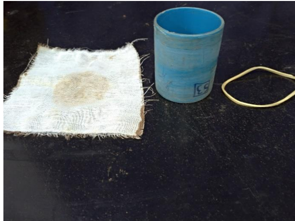
Figura 1 – Material utilizado para montagem e vedação dos anéis
