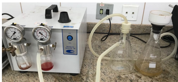
Figura 9 - Bomba de vácuo utilizada para remoção do excesso de água
