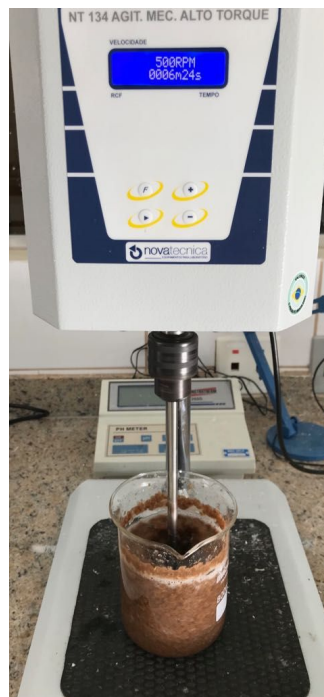
Figura 8 - Agitador mecânico no laboratório de Biomateriais da UFLA
