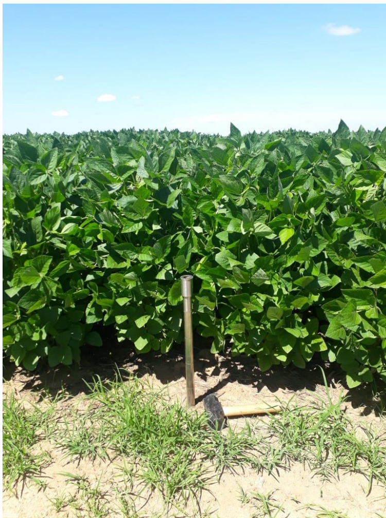
Figura 16 – Trado para retirada de amostras de solo em lavoura de soja
