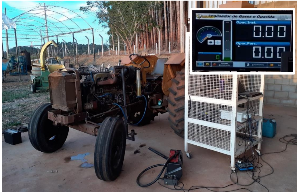
Figura 11 – Trator, aparatos experimentais e display do opacímetro.
