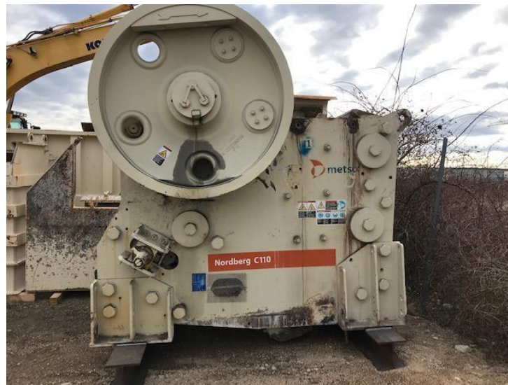
Figura 3 – Britador de mandíbula Metso C110 que realiza o primeiro processamento da rocha proveniente da jazida.
