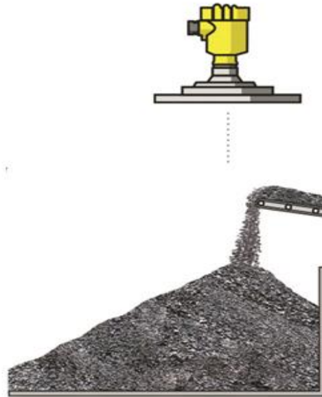
Figura 20 – Sensor de nível (Radar) responsável pelo monitoramento do nível de pilhas de brita.
