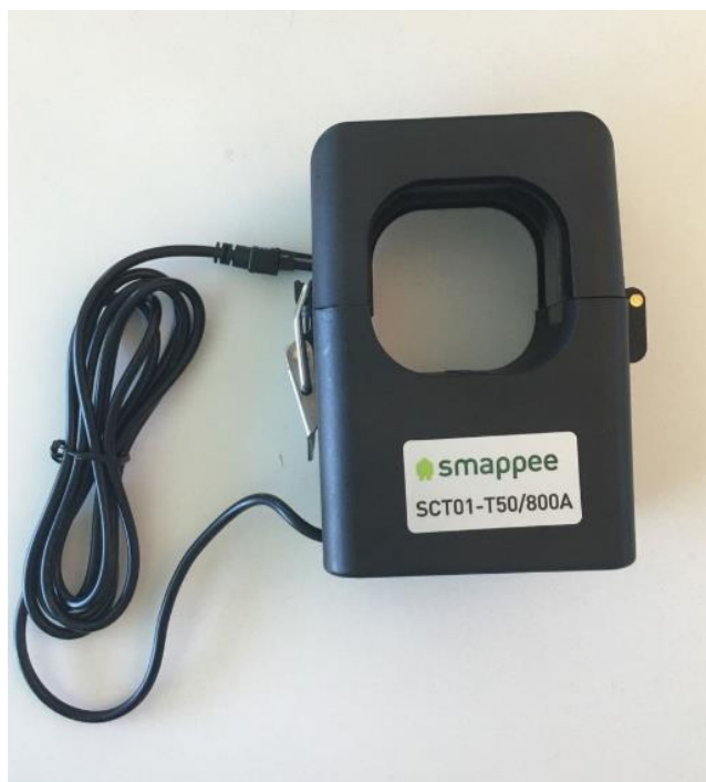
Figura 22 – Sensor de corrente elétrica não invasivo (Transformador de corrente). Sensor Utilizado para monitorar a corrente elétrica dos motores mais críticos da planta de britagem.
