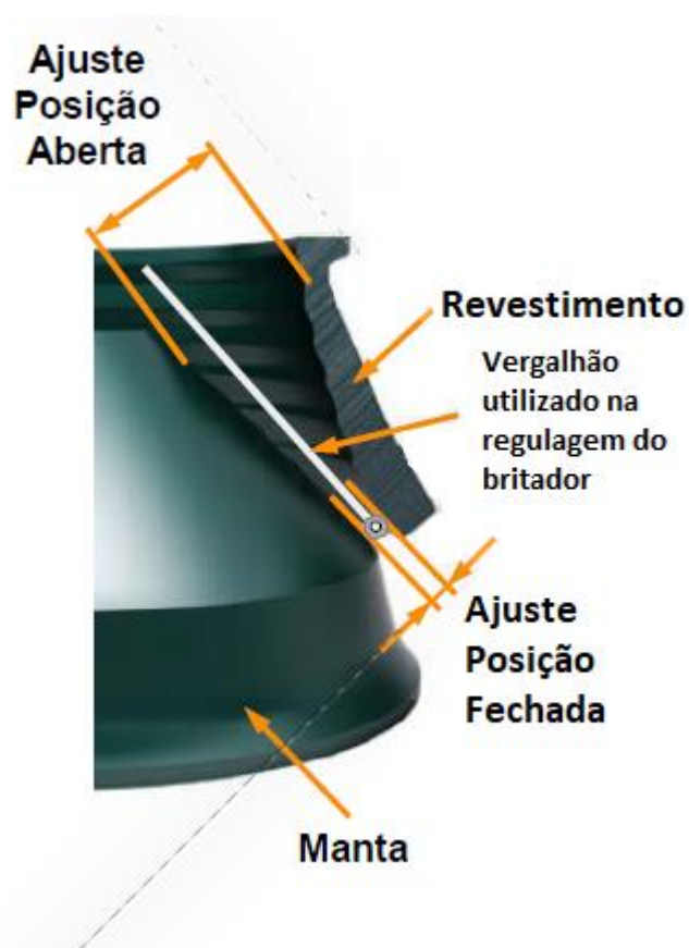
Figura 7 – Manta e revestimento, conjunto de desgaste e suas posições aberta e fechada (A.P.A e A.P.F).
