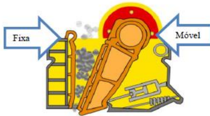
Figura 4 – Funcionamento do Britador de mandíbula. Em destaque estão as mandíbulas, móvel e fixa, que são as peças de desgaste do britador primário.
