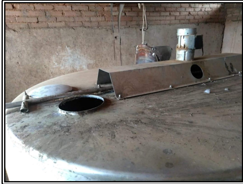
Figura 5 - Diagnóstico de linha. Falha na limpeza e higienização do tanque de expansão, do laticínio A (MG).
