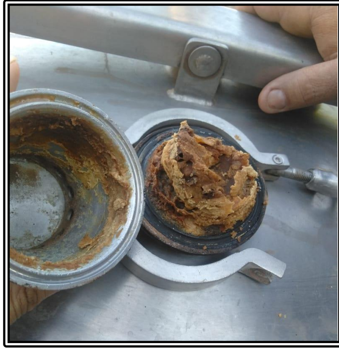
Figura 9 - Diagnóstico de situação dos caminhões. Falha no processo de limpeza do suspiro do caminhão do laticínio A (MG).
