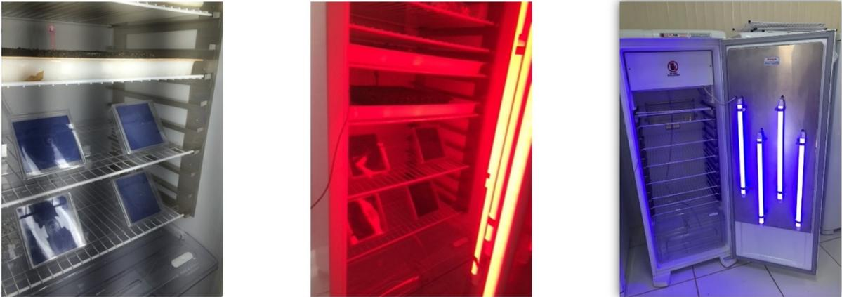
Figura 3: Equipamento do tipo BOD adaptadas com luz branca, vermelha e azul.
