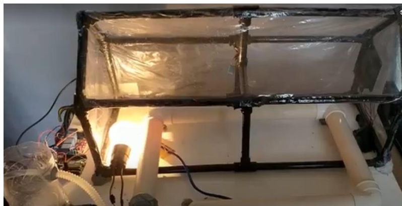
Figura 16 – Protótipo da estufa com a lâmpada para aquecimento acesa.
