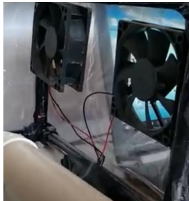
Figura 15 – Ventoinhas de CPU simulando os exaustores.
