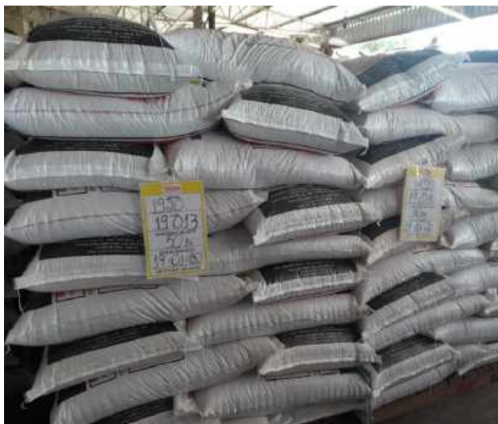
Figura 73 – Lote de Produto Acabado com ficha de identificação amarela sinalizando lote interdito por não conformidade.
