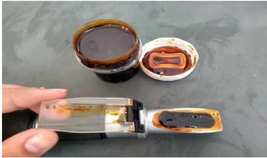
Figura 65 – Amostra de melão espalhada na lente do refratômetro.
