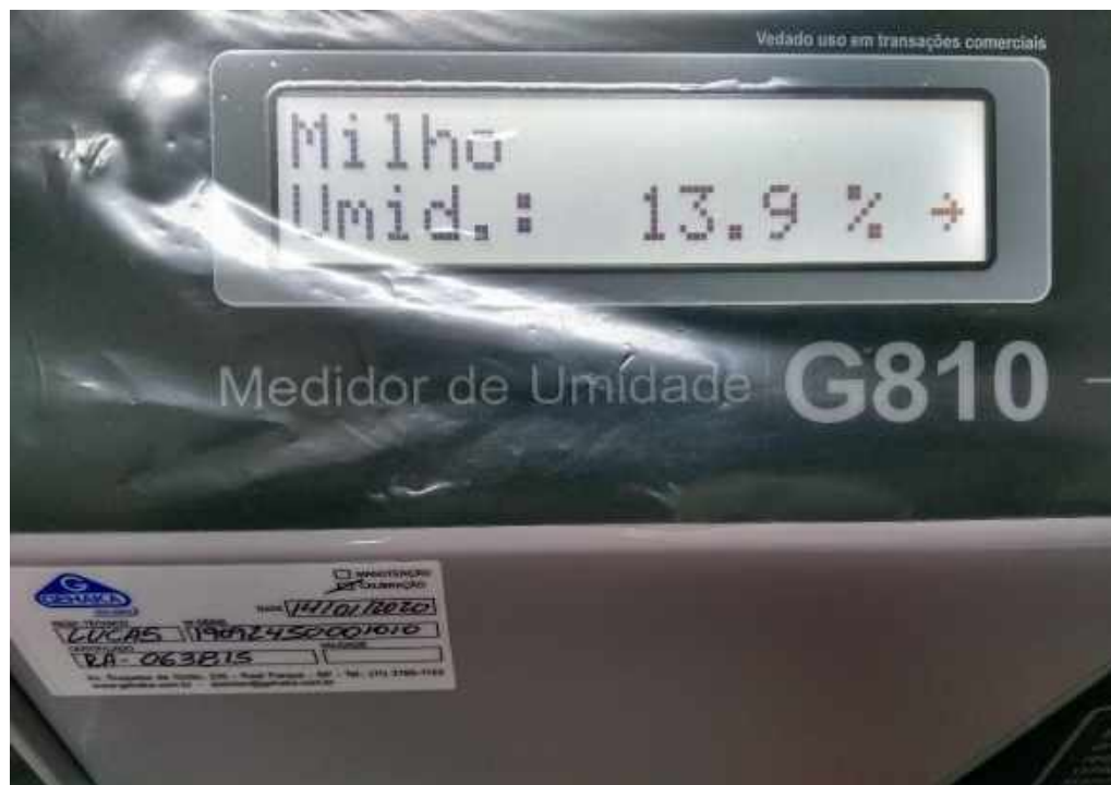
Figura 59 – Análise do teor de umidade do milho no medidor de umidade de grãos.
