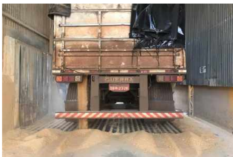
Figura 29 – Matéria-prima sendo descarregada na Moega.
