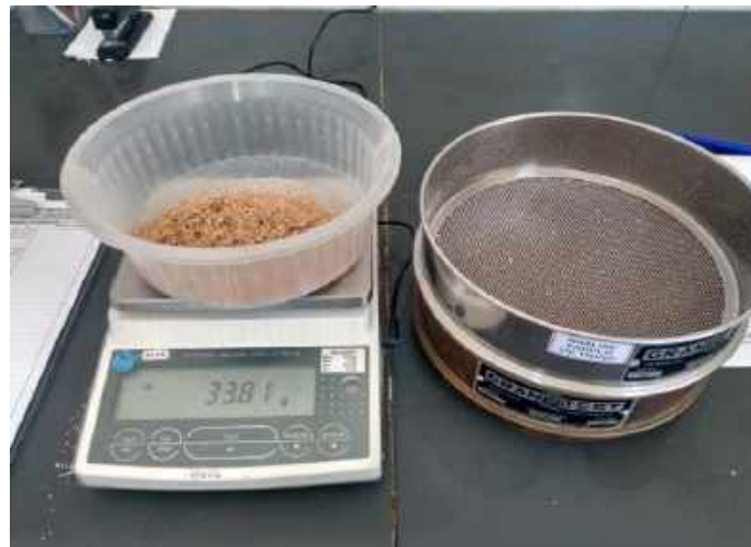
Figura 62 – Análise da porcentagem de perda de casca do farelo de trigo.
