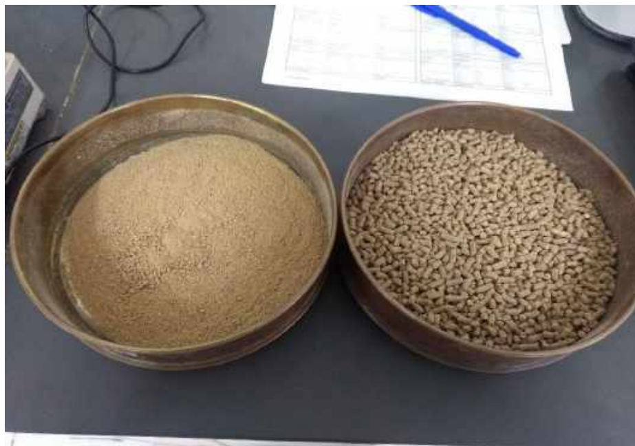
Figura 78 – Peneiragem da amostra retirada do Durabilímetro para retirada dos finos.
