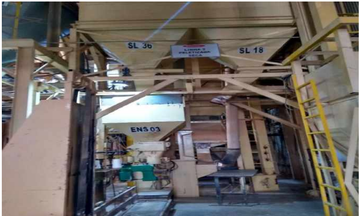
Figura 14 – Linha 3: Peletizada Seca (Prensa de 100cv).
