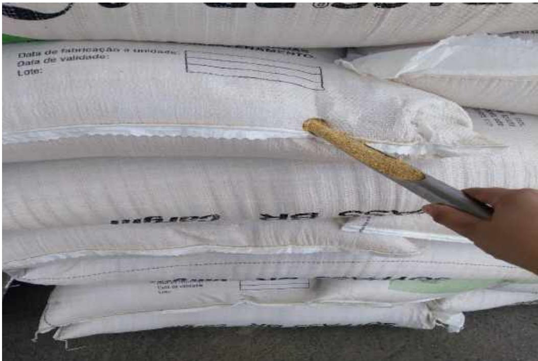
Figura 47 – Retirada do calador de sacaria contendo a parcela de amostra.
