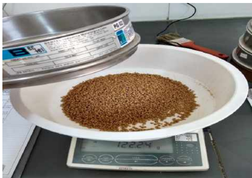
Figura 75 – Pesagem de parcela de amostra retida em peneira granulométrica.
