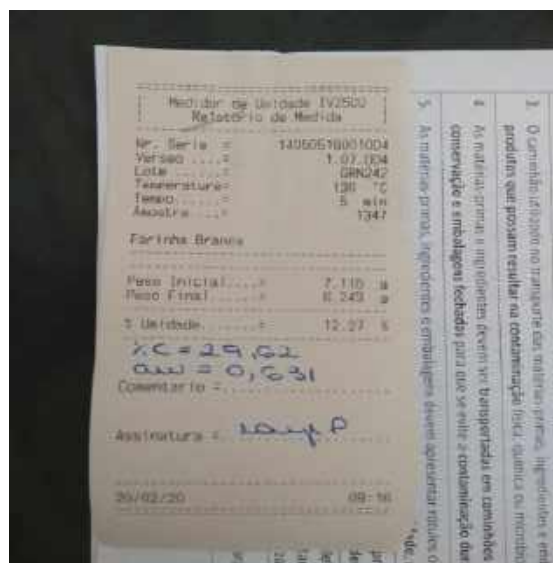
Figura 63 – Resultado da análise de teor de umidade.
