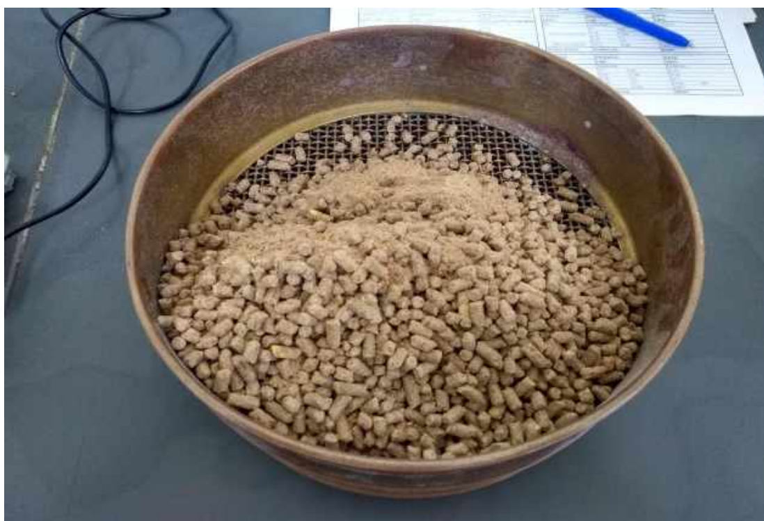
Figura 76 – Amostra de ração sendo peneirada para retirada dos finos.
