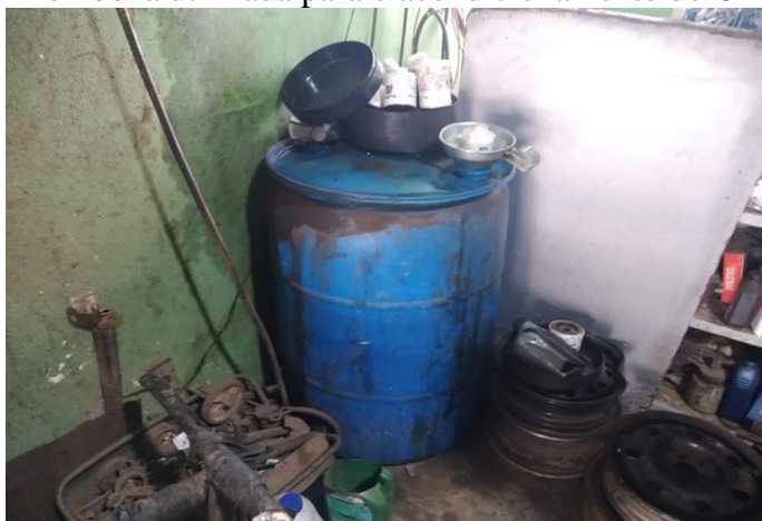
Figura 16 - Bombona utilizada para o acondicionamento do OLUC gerado.
