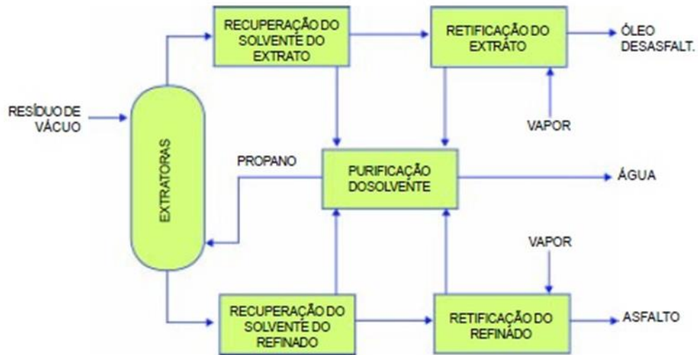
Figura 3 - Diagrama esquemático da desasfaltação a propano.
