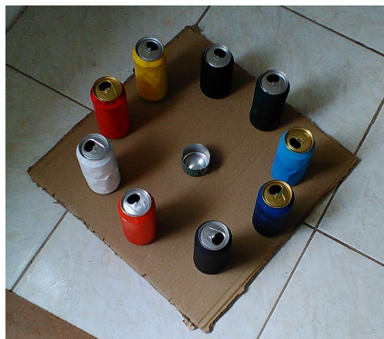
Figura 4.1 – Disposição das latas e da fonte de calor para a realização do experimento de aquecimento das latinhas
