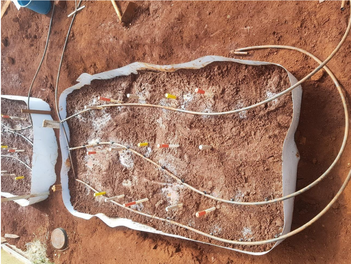
Figura 7. Fase de saturação do solo dos canteiros.
