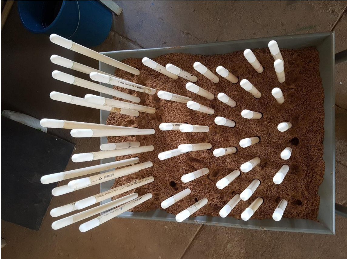
Figura 4: Colagem das capsulas porosas nos tubos PVC.
