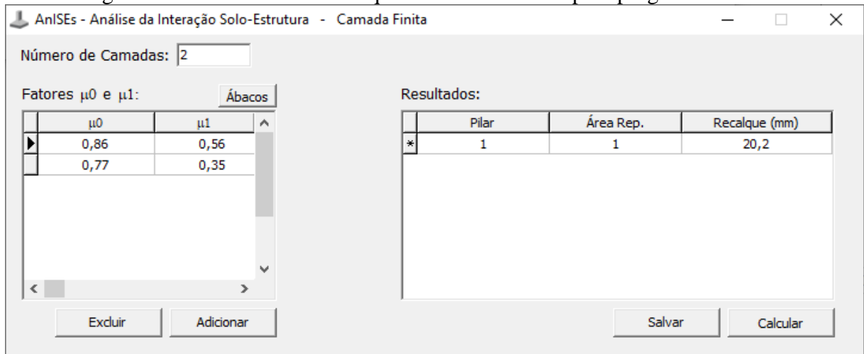
Figura 30 – Estimativa do recalque em multicamadas pelo programa AnISEs.
