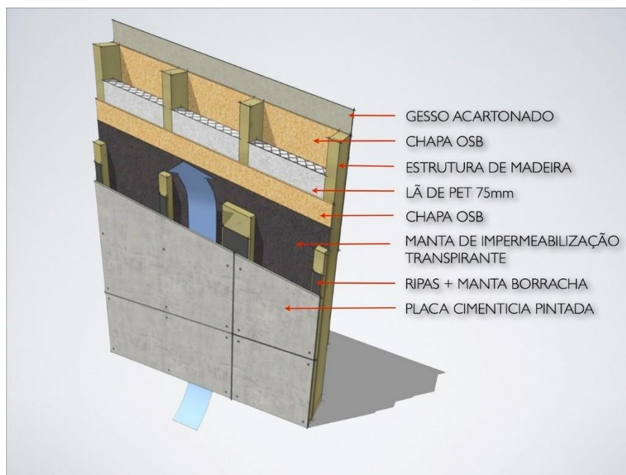
Figura 23 – Desenho esquemático das camadas do quadro estrutural.
