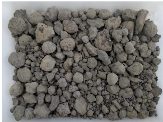
Figura 3.4 – Amostra de clínquer cedida pela InterCement.
