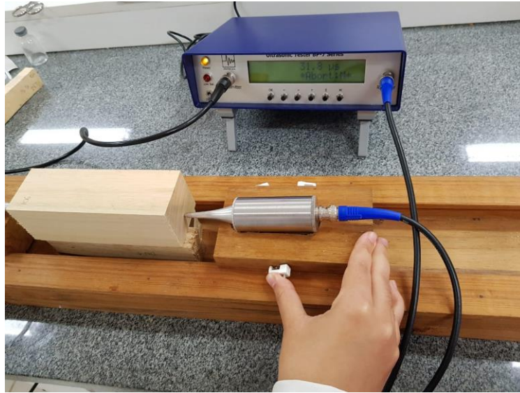
Figura 1: Ensaio com o Equipamento de Ultrassom (Ultrasonic-Teste BP-7).
