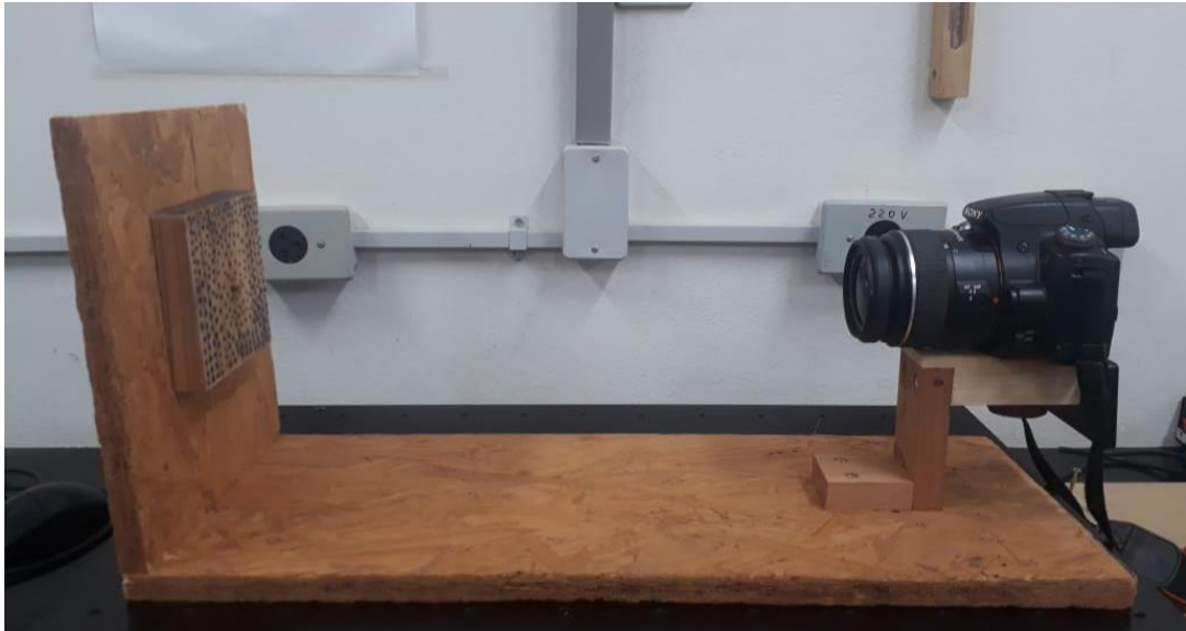
Figura 1: Vista geral da do aparato montado para realização do ensaio, da câmera profissional utilizada, e de um dos corpos de prova utilizado.
