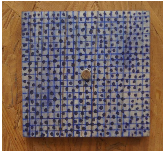
Figura 2: Traçado das retas horizontais e verticais nos corpos de prova.
