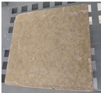
**Figura 1:** Chapa de gesso acartonado desmoldado.
