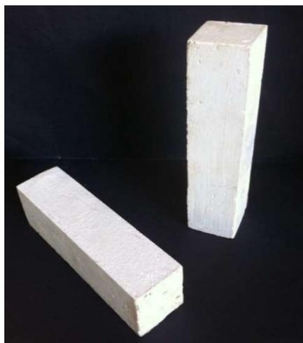
**Figura 1:** Corpos de prova prismáticos desmoldados.
