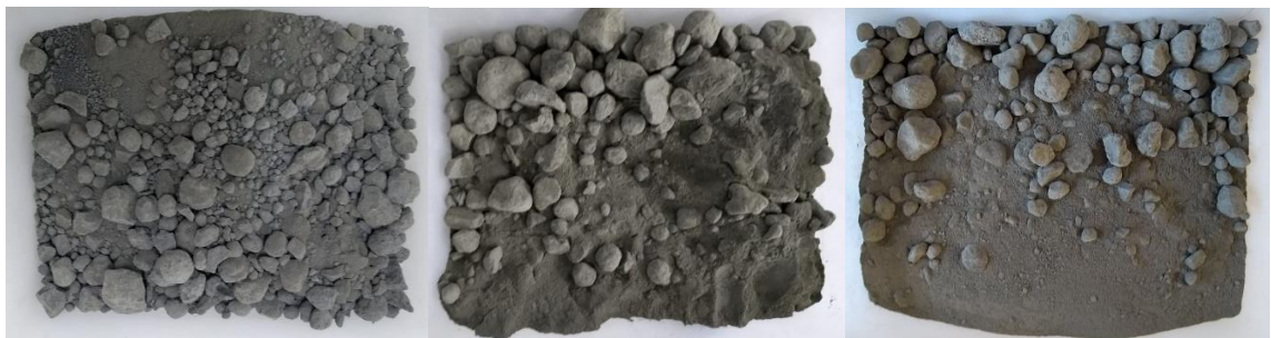
Figura 4.14 - Amostra final da moagem com 6% de corpos moedores a 15, 31 e 47 rpm, respectivamente.
