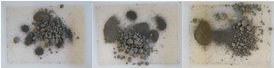
Figura 4.6 - Moagem com 4% de corpos moedores a 31 rpm após 5, 10 e 15 minutos de peneiramento, respectivamente.
