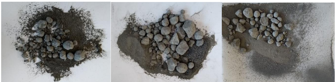
Figura 4.10 - Moagem com 6% de corpos moedores a 47 rpm após 5, 10 e 15 minutos de peneiramento, respectivamente.
