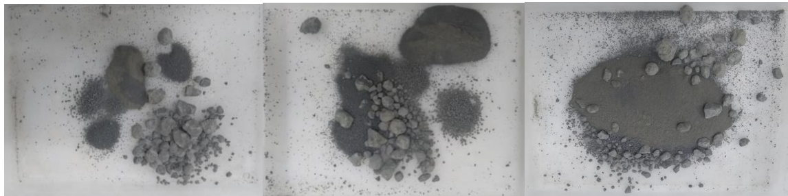
Figura 4.7 - Moagem com 4% de corpos moedores a 47 rpm após 5, 10 e 15 minutos de peneiramento, respectivamente.
