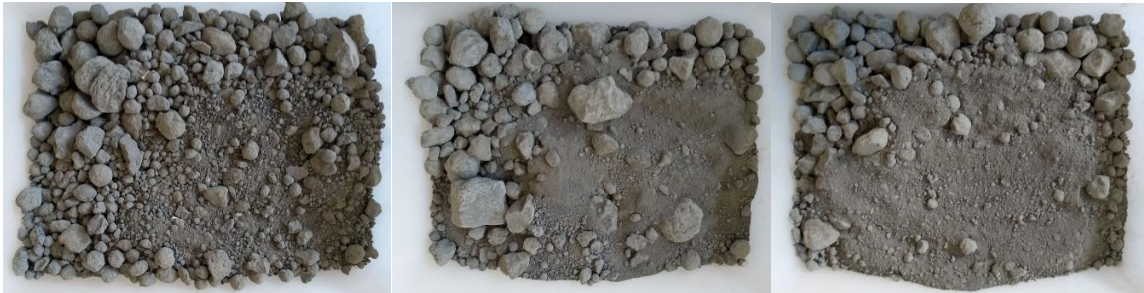
Figura 4.12 - Amostra final da moagem com 2% de corpos moedores a 15, 31 e 47 rpm, respectivamente.
