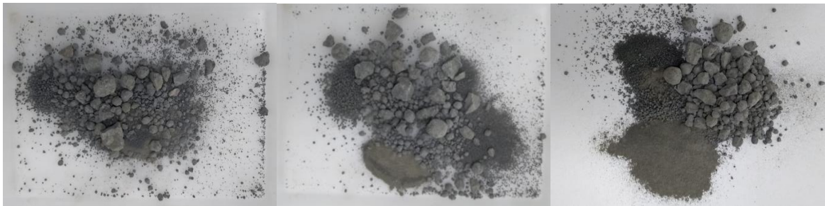
Figura 4.8 - Moagem com 6% de corpos moedores a 15 rpm após 5, 10 e 15 minutos de peneiramento, respectivamente.
