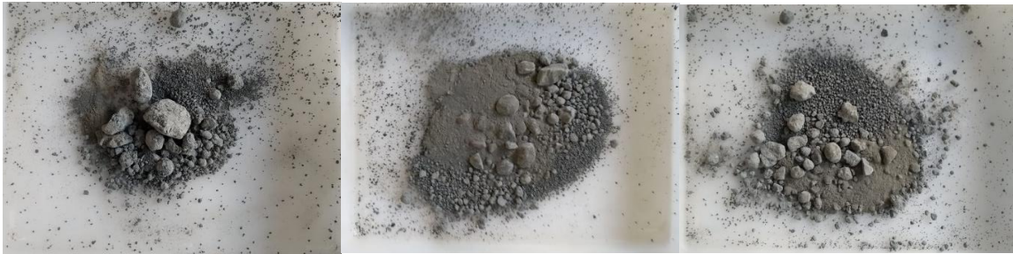
Figura 4.4 - Moagem com 2% de corpos moedores a 47 rpm após 5, 10 e 15 minutos de peneiramento, respectivamente.
