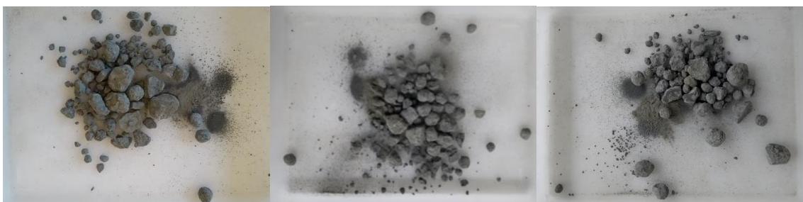
Figura 4.5 - Moagem com 4% de corpos moedores a 15 rpm após 5, 10 e 15 minutos de peneiramento, respectivamente.
