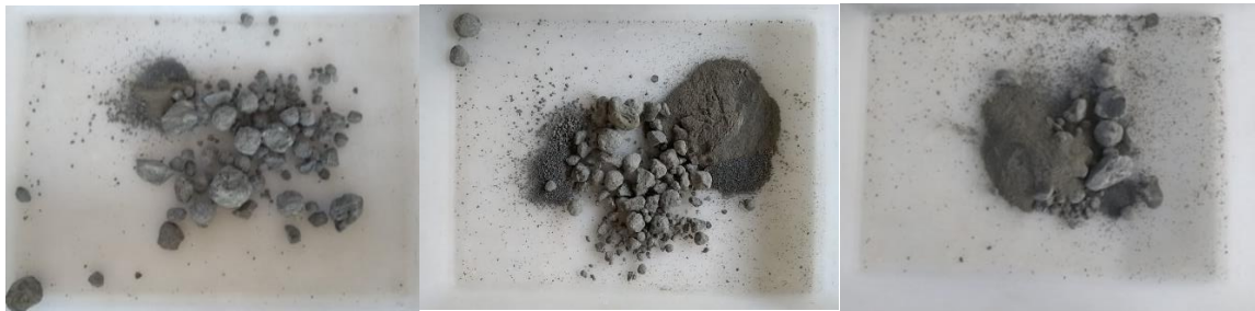
Figura 4.9 - Moagem com 6% de corpos moedores a 31 rpm após 5, 10 e 15 minutos de peneiramento, respectivamente.
