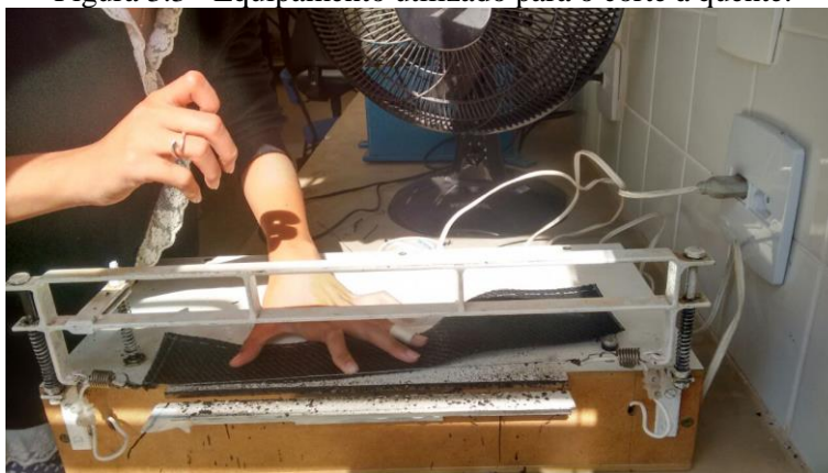
Figura 3.3 - Equipamento utilizado para o corte à quente.
