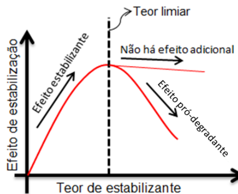
Figura 2.6 - Esquema da variação do efeito do aditivo em função da sua concentração.
